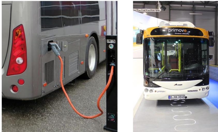
ABBILDUNG 4: LADEN ÜBER KABEL UND INDUKTIONS-LADUNG (FOTOS: DR. THEIßEN)
