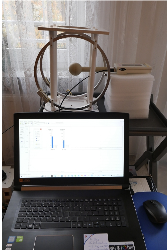
Abb. 4 Gerätetest mit Helmholtzspulen
